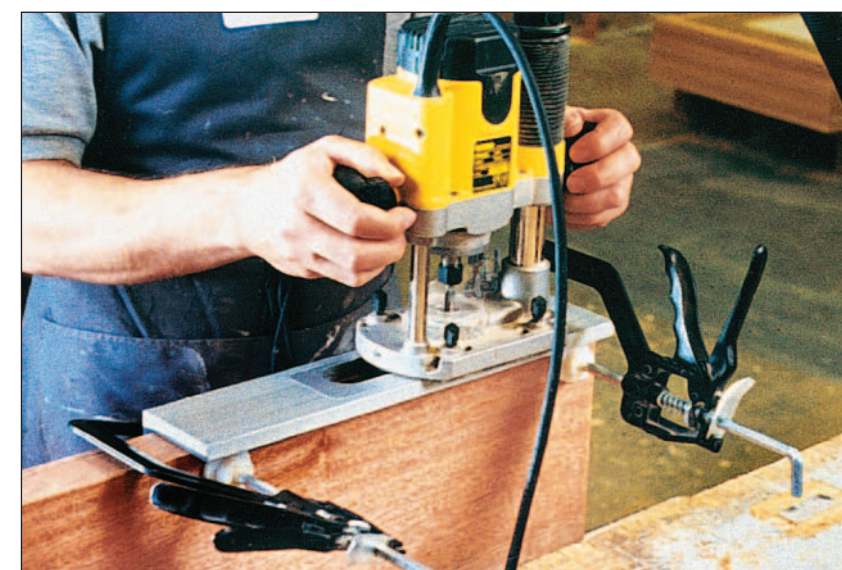
Er zijn slechts twee (lijm)klemmen nodig om de grondplaat met het inleg-precisiesjabloon op het werkstuk te klemmen (klemmen niet meegeleverd).
