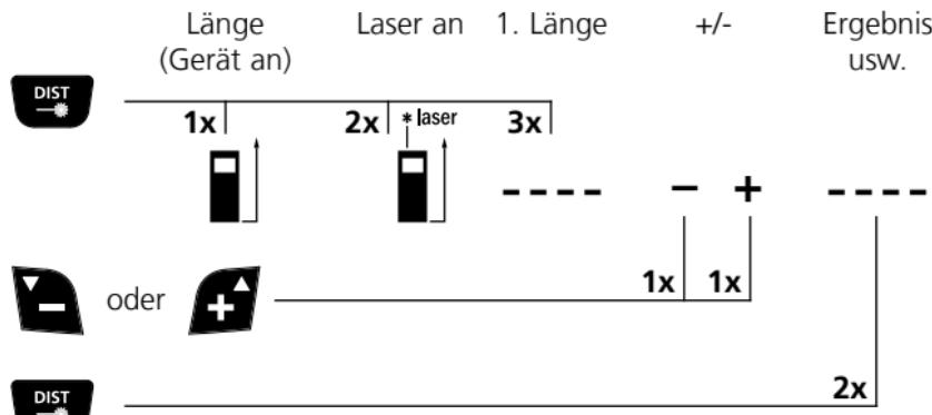
Weitere Längen werden durch Drücken der Taste DIST hinzugefügt.
