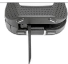
Für Anschlagmessungen den Pin zur Seite klappen und die Einstellung „Messebene hinten“ wählen.
