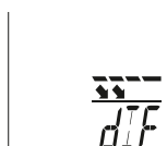
8. Rozdíl infračerveného měření teploty (max. / min.)
