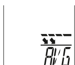
7. Průměrná hodnota infračerveného měření teploty
