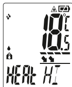
Okolní teplota: 12°C Tepelný most, displej svítí červeně a zazní signál
