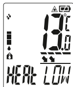
Okolní teplota: 20°C Tepelný most, displej svítí modře a zazní signál
