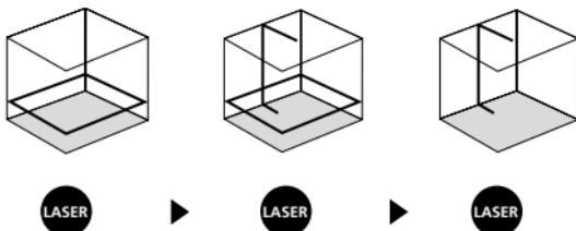
! Voor de horizontale en verticale nivelleren moet de transportbeveiling gedeactiveerd zijn. Zodra het apparaat zich buiten het automatische nivelleerbereik van  $3^\circ$  bevindt, knipperen de laserlijnen. Positioneer het apparaat zodanig dat het zich binnen het nivelleerbereik bevindt.
